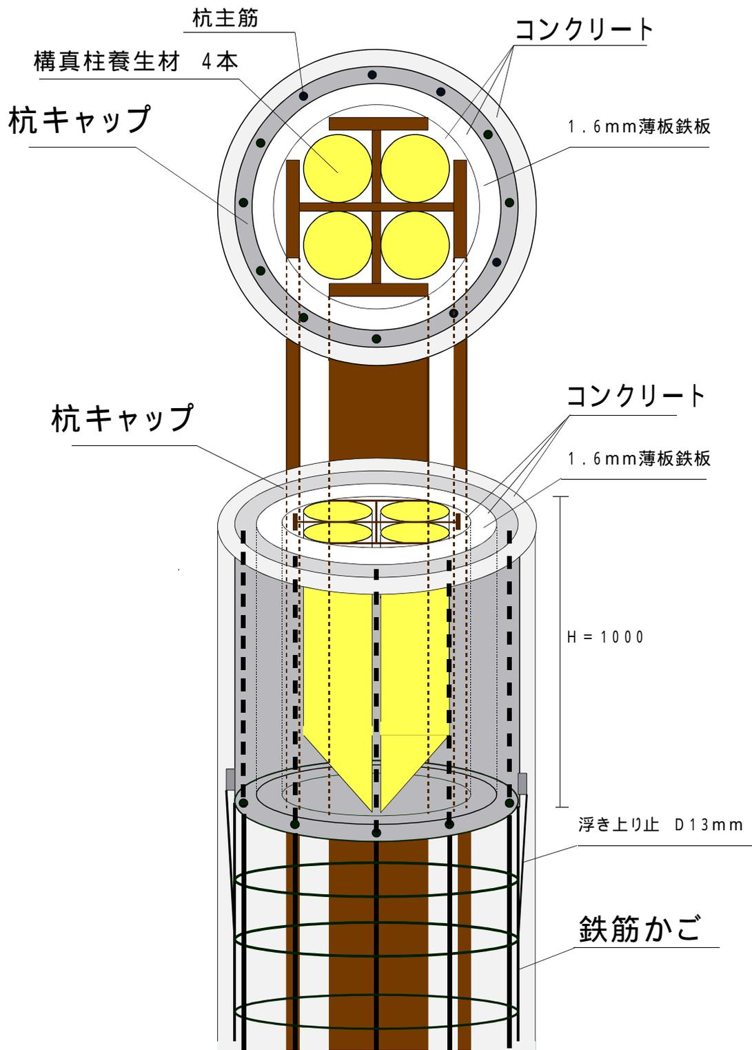
特許 杭キャップを備えた構真柱の杭頭処理具
